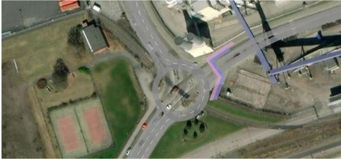
Figur 38 Illustration över möjlig cirkulation som ersättning till signalkorsning 2 utmed von Utfallsgatan.
