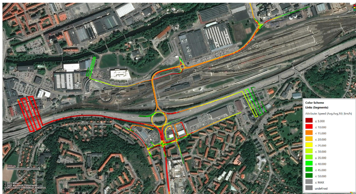
Figur 41 Illustration över medelhastigheten med dagens utformning (med ny placering av infart till ICA:s parkering) och trafikflöden enligt scenario 1.
