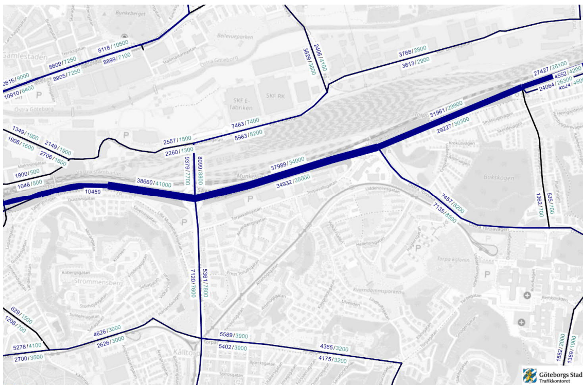
Figur 8 Okalibrerat Nuläge (Dygn). Mörkblå siffror visar trafikmängd i modellen och ljusblå siffror visar trafikmätningar. Flödena avser ÅMVD på alla kommunala gator, medan det avser ÅDT på E20.
