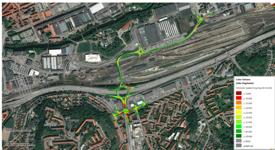
Figur 39 Illustration över medelhastigheten med dagens utformning och trafikmängder. Färgskalan kan ge sken av att det är kortare köer än vad man förväntar sig (utifrån bland annat drönarfilmerna), men bedöms ändå stämma utifrån visuella iakttagelser under simuleringen samt utifrån uppmätta kölängder som redovisas nedan.
